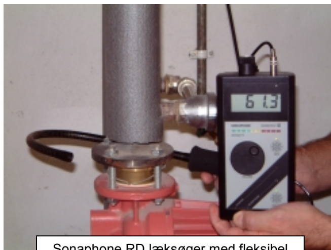
Sonophone RD læksøger med fleksibel målerør til utilgængelige målesteder
