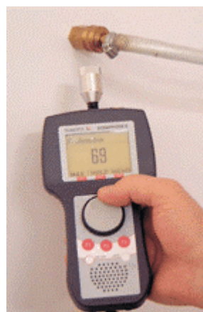
Sonophone E ultralydbaseret læksøger beregnet til eksplosionsfarlige områder
